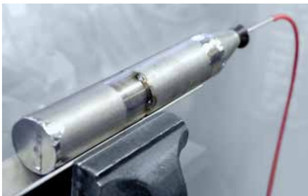
Sintermetall Formierfinger zum Formieren von Rohren
