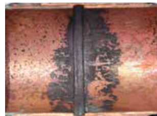
Kupferrohr gelötet: ohne Formiergas
