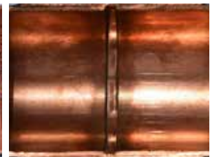
Kupferrohr gelötet: Formiergas Argon
