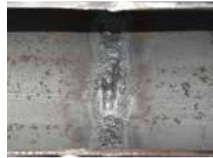
Rohr aus Stahl: ohne Formiergas
