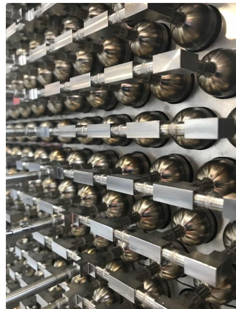
Mit Metallhydrid gefüllte Stacks in einer Verdichtungseinheit
